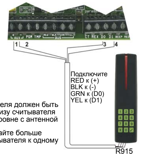
Рисунок 2: Подключение R915 ACM12 (V4.0 или выше)
