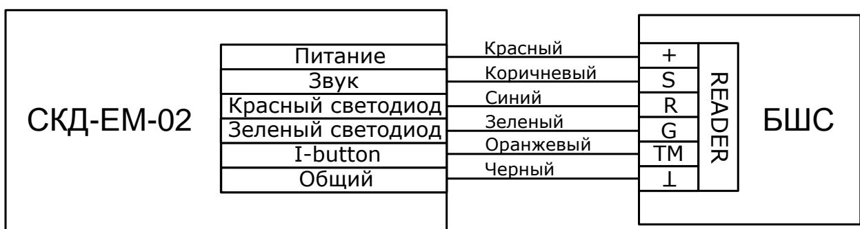
Режим индикации считывателя при конфигурировании БШС должен быть сконфигурирован, как "Proximity", тип индикации должен быть установлен – "СО".
