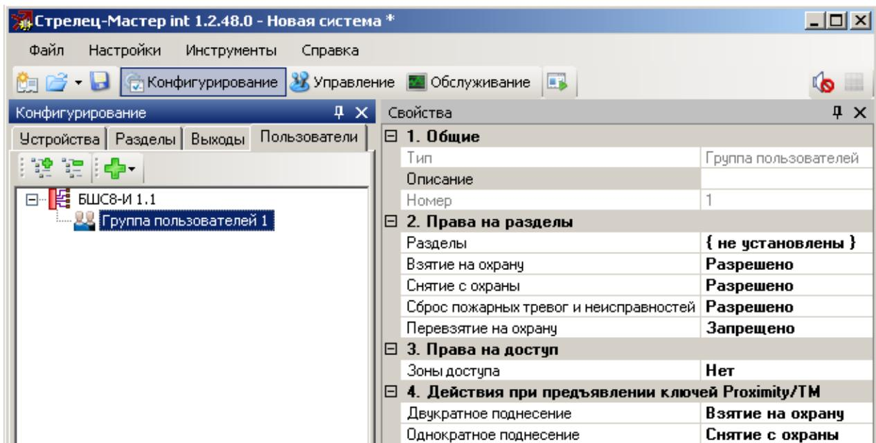
5. При необходимости определить опции контроля доступа для реле, считывателей и групп пользователей (см. 4.6).
