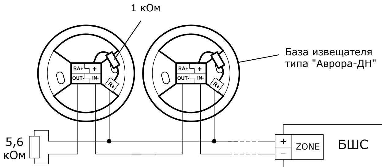
**3.** Подключение **нормально разомкнутых пожарных** извещателей с выходом типа "сухой контакт" (тип ШС - пожарный дымовой, с распознаванием или без распознавания сработки двух извещателей):
