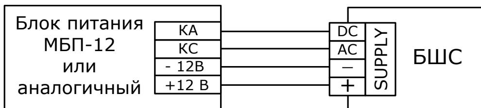
При использовании блока питания без выходных сигналов о состоянии сетевого и резервного источников питания возможно отключить контроль линий AC и DC при конфигурировании БШС, либо соединить цепь контроля AC БШС с положительной клеммой питания, установив перемычку "AC", находящуюся на печатной плате БШС.
