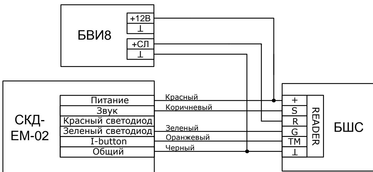
Режим индикации считывателя при конфигурировании БШС должен быть сконфигурирован, как "Proximity", тип индикации должен быть установлен – "БВИ8 (разделы)" или "БВИ8 (ШС)".
