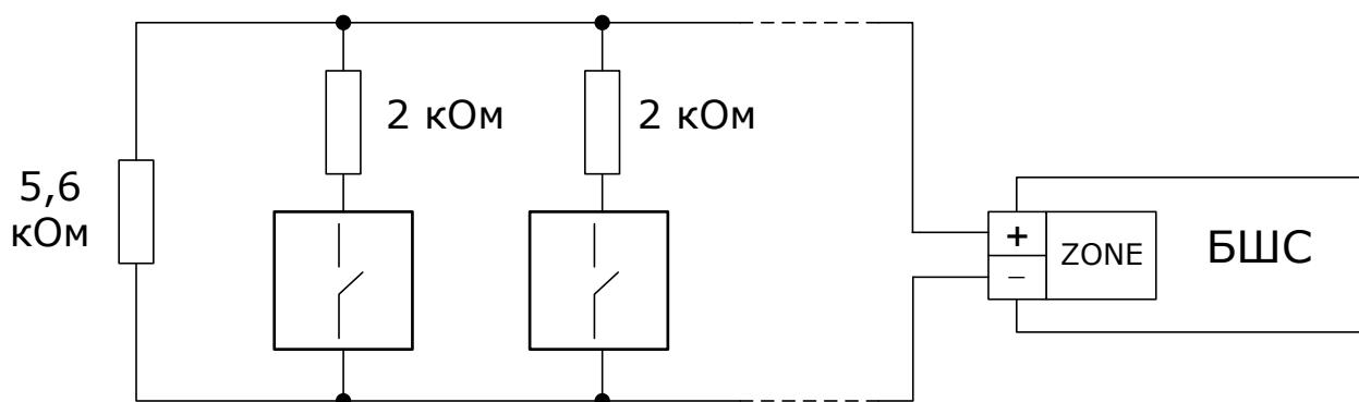
**4.** Подключение **нормально замкнутых пожарных** извещателей с выходом типа "сухой контакт" (тип ШС - пожарный тепловой, с распознаванием или без распознавания сработки двух извещателей):
